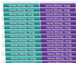
Figura 1.4: Execução concorrente entre kernels de mesma cor na arquitetura Kepler [7] onde o eixo x representa o tempo
