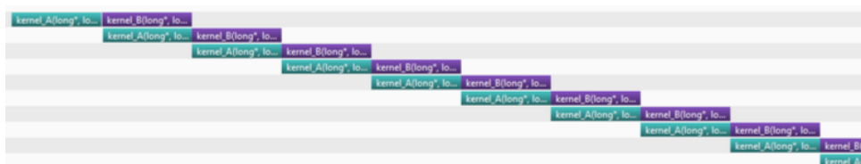
Figura 1.3: Execução concorrente entre kernels de mesma cor na arquitetura Fermi [7] onde o eixo x representa o tempo
